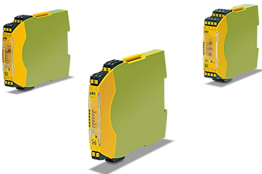
Защитные реле PNOZs5 и PNOZs9 могут использоваться как таймеры для контроля аварийного останова, защитного ограждения или световой завесы. Реле-таймер PNOZs5 является основным блоком и может обесточивать. Защитное реле PNOZs9 может использоваться для задержки отключения/включения или как импульсный таймер. Оно также может использоваться вместе с основным блоком как модуль расширения для увеличения числа контактов замедленного или мгновенного действия.
